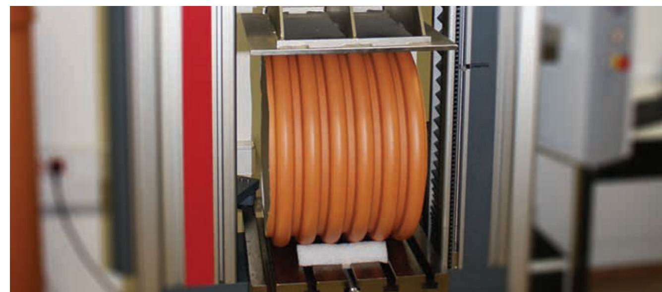
лабораторные испытания трубы Polytron ProKan
